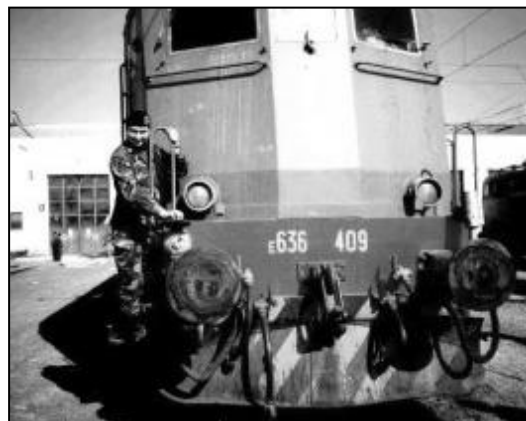
L'attuale macchinista ed ex geniere mostra la condotta a 78 poli della E 636.409 attrezzata per i servizi navetta
