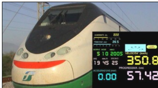
Foto di Trenitalia che testimonia il raggiungimento della velocità di 350,8 km/h da parte dell'ETR 500 n. 31. Il nuovo record italiano è stato raggiunto il 6 ottobre 2005 alle 19.45 tra Saluggia e Balocco nel vercellese durante una corsa prova sulla nuova linea ad Alta Velocità Torino-Novara.
