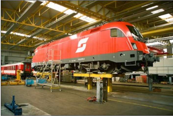
La 1116 079 sollevata su cavalletti nelle officine del deposito di Villach il 2 giugno 2004 (foto D. De Anna)
